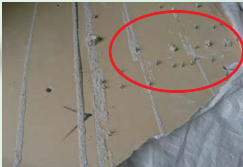
受入れた廃石膏ボードの中には上の写真のようにタッカー等が付着した状態のものもあり、手作業で除去を行っている。
