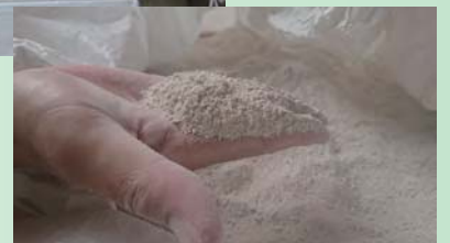
破碎分別機によって、紙と石膏粉に分離し、粒度調整等を行います。（処理能力：約1.78 t/h）
