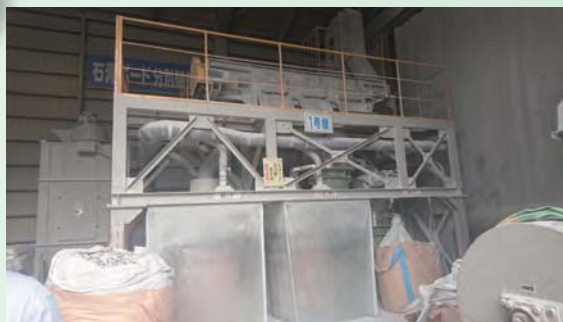
破碎分別機によって、紙と石膏粉に分離し、粒度調整等を行います。（処理能力：約1.78 t/h）
