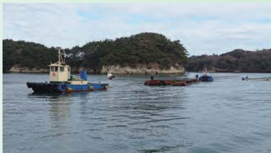
浚渫している場所から土運船で土砂が運ばれる。
